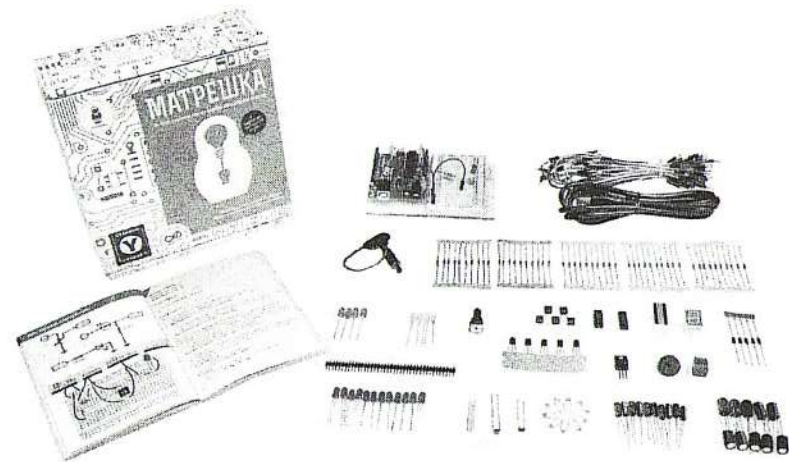
Рис. 3. Электронный конструктор «Матрешка Y»
